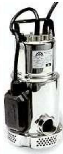
3. Collocare la pompa direttamente sul fondo vuol dire che lo svuotamento avverrà fino a pochi millimetri d'altezza di acqua residua, ma aumenta la possibilità di aspirare morchie e fanghiglie, riducendo la portata della pompa. Va dunque valutata la collocazione della pompa in base al tipo di lavoro che si deve fare; si può anche lavorare in più fasi, con pompa sospesa a diverse profondità.
