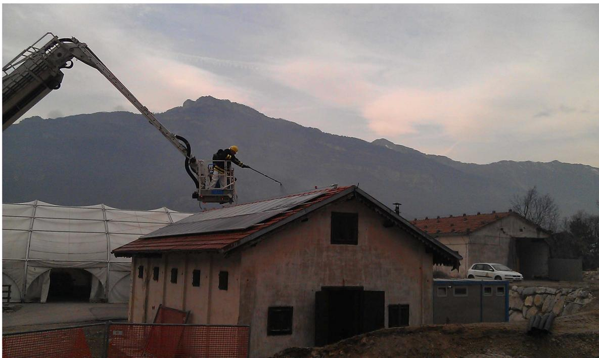
Figura 5-23: prova con Prevento Solar: prima spruzzata
