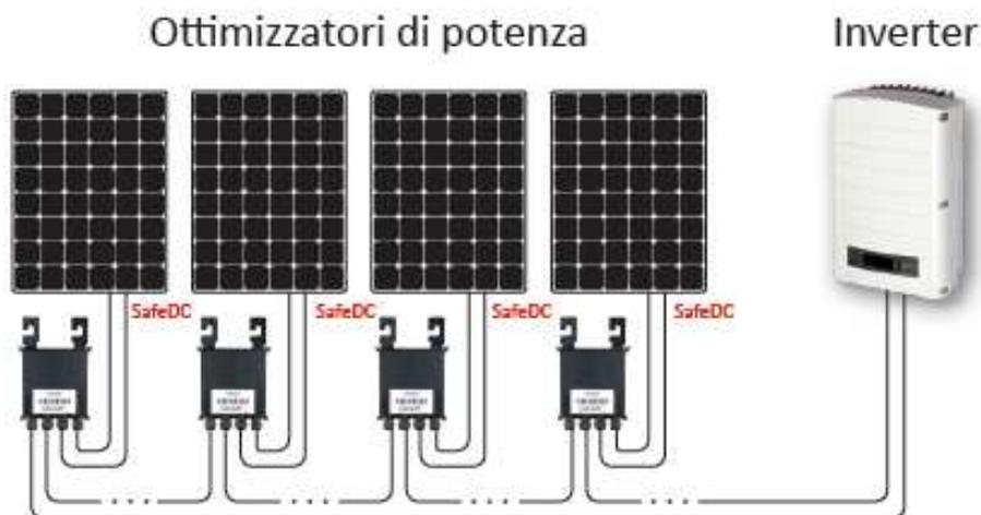
Figura 4-4: architettura del sistema SOLAREEDGE
