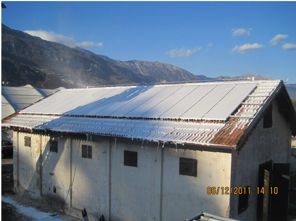
Figura 5-6: prova con CAFS: schiumaggio completato
