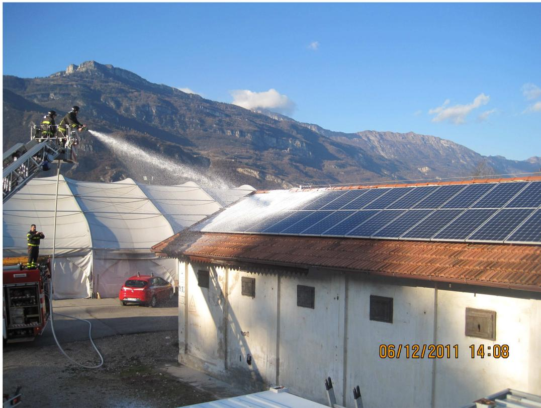
Figura 5-5: prova con CAFS: fase di schiumaggio
