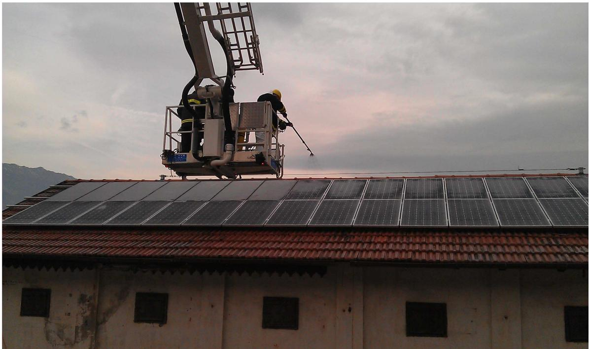
Figura 5-22: prova con Prevento Solar: prima spruzzata
