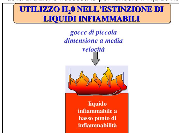
Per esempio per il whisky il rapporto di miscelazione è di 1,5 volumi di acqua per 1 di whisky, per l'alcool etilico il rapporto è di 7 ad 1 e per l'acetone di 30 ad 1. Nel caso quindi di diluizioni troppo elevate esiste sempre il pericolo del traboccamento se il volume del contenitore non è sufficiente.
