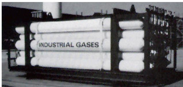
Fig.47 - Contenitori di gas sotto pressione.
