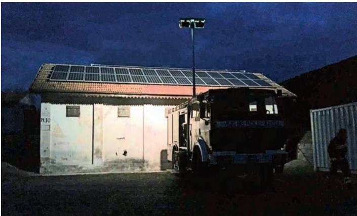
**PROVE NOTTURNE.** Sono stati simulati interventi di notte con l'ausilio dei fari in uso ai VVF di Trento. Nei diversi casi, si arriva a tensioni di circuito aperto anche superiori a 60 Volt, ma collegando il reostato, le correnti di elettrocuzione sono risultate molto basse, inferiori a 0,01 A.
