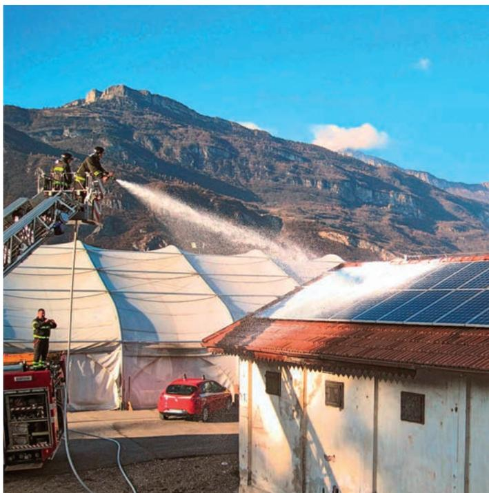
**PROVE CON SCHIUME ANTINCENDIO TIPO CAFS (COMPRESSED AIR FOAM SYSTEM).** La schiuma è in grado di ridurre la tensione iniziale di circa il 5%, per un tempo molto breve, poiché il materiale tende a scivolare sulla superficie dei pannelli, come evidenzia il grafico a destra. Risulta pertanto inefficace nel ridurre le tensioni dell'impianto FV.
