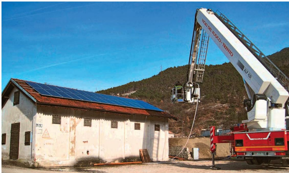
**PROVE CON IMPIANTO IN CONDIZIONI STANDARD.** Il rischio per i soccorritori si conferma elevato. In una giornata con buon irraggiamento solare, dove si possono superare anche i 1000 W/m<sup>2</sup>, entrare in contatto con la corrente prodotta dall'impianto FV può causare contrazioni muscolari e fibrillazione ventricolare, con conseguente rischio di infarto.
